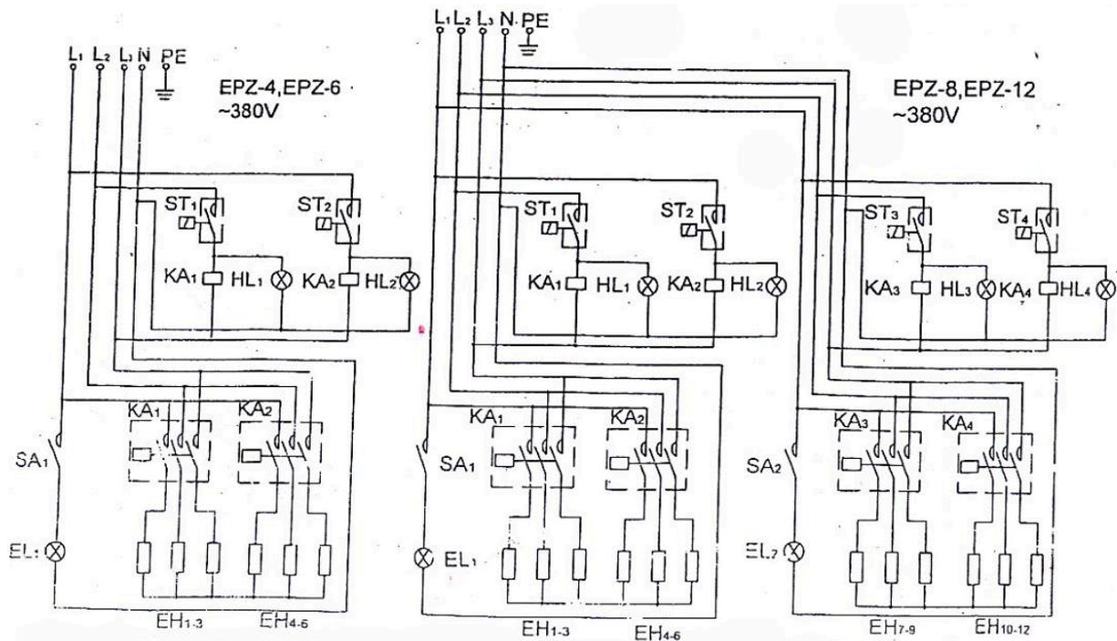
SA: Реле (16А, 220В) ST: Контроллер Термостата (EPZ-2/16А, 350°; EPZ-4/6/8/12, 16А, 450°)
